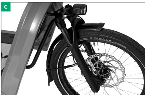
9. Votre VELO DE VILLE FR8 est équipé d'une fourche à suspension [c]. Nous vous conseillons de confier le réglage de la fourche à suspension à votre revendeur VELO DE VILLE. Un réglage incorrect de la fourche à suspension peut en effet entraîner un mauvais fonctionnement, voire une détérioration de la fourche. Il affectera dans tous les cas le comportement du vélo et ne vous permettra pas de jouir d'une sécurité de conduite maximale.
